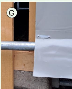
G) Beschwerungsrohr (10) in den Hohlraum des Behangs (9) einfahren.
