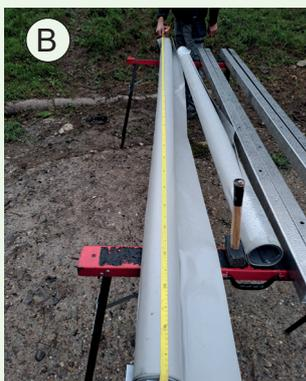
B) Länge von Ende Getriebe bis Ende Walzenzapfen messen → Länge wird benötigt für das Setzen der Winkellager.
