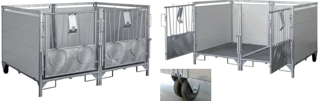
Robuste Erweiterung, problemlos per Hand oder Frontlader verfahrbar. Flexibler, einfacher Umbau zwischen Doppel- und Einzelboxen.
