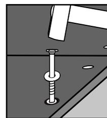
Nagel und Unterlegscheibe einschlagen bis sie gleichmäßig fest aufliegen und etwas versenkt sind
