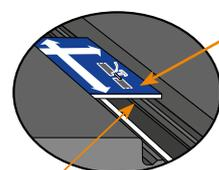
Für die lockere Verlegung Mattenabstand mit Hilfe der Montagelehren (breiter als Profil) einrichten
