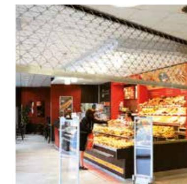
Rollgitter TG-X als Schutz-/Trennungsgitter in einer Ladenpassage
