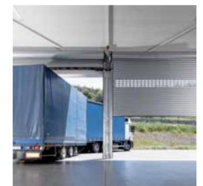
Sicher ist sicher: Erst wenn der Pfosten fest verriegelt ist, lässt sich das Tor bewegen. So kann es nicht zu einem versehentlichen Herunterlassen des Tores kommen. Ein Sensor erkennt, ob der Pfosten richtig verriegelt ist.
