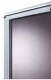
Rahmenprofil mit 20-mm-KS-Doppelscheibe – grau getönt; Lichtdurchlass: ca. 43%
